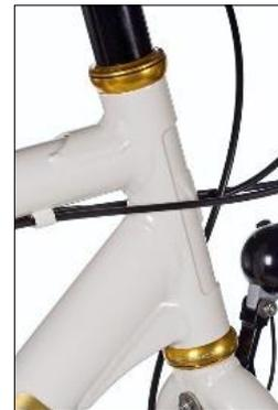
Aus dieser flächigen „Rohrsammelstelle“ holt das Velotraum überragende Lenkkopf-Stabilität. Das Gold am Rad ist hoch verdient.
