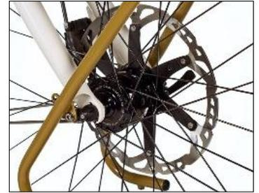
Die groß dimensionierte Bremsscheibe garantiert Standfestigkeit auch noch mit zig Kilos Gepäck bei zig Prozent Gefälle.
