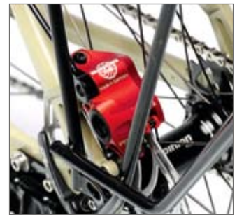
Ungewöhnlich: die BrakeForceOne arbeitet mit Bremskraftverstärker.
