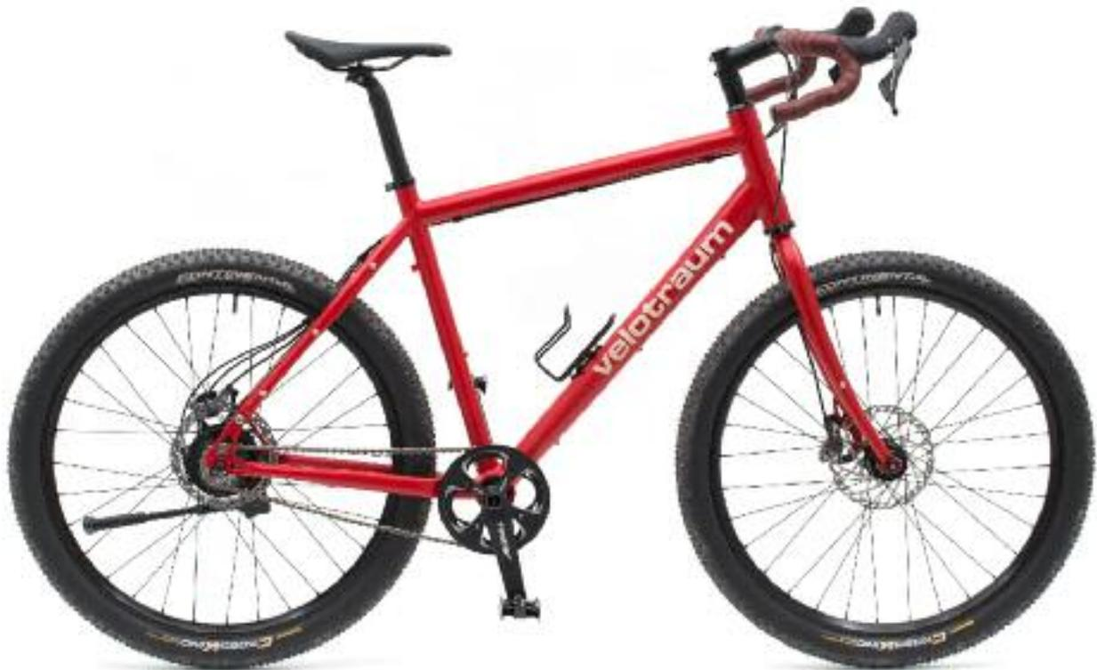
Abbildung: Ausstellungsrad – Rahmen: VT900 – Farbe: RAL 3002 – Größe »XL« – Reifenformat: 57-584 mm – Gewicht: 13,6 kg
