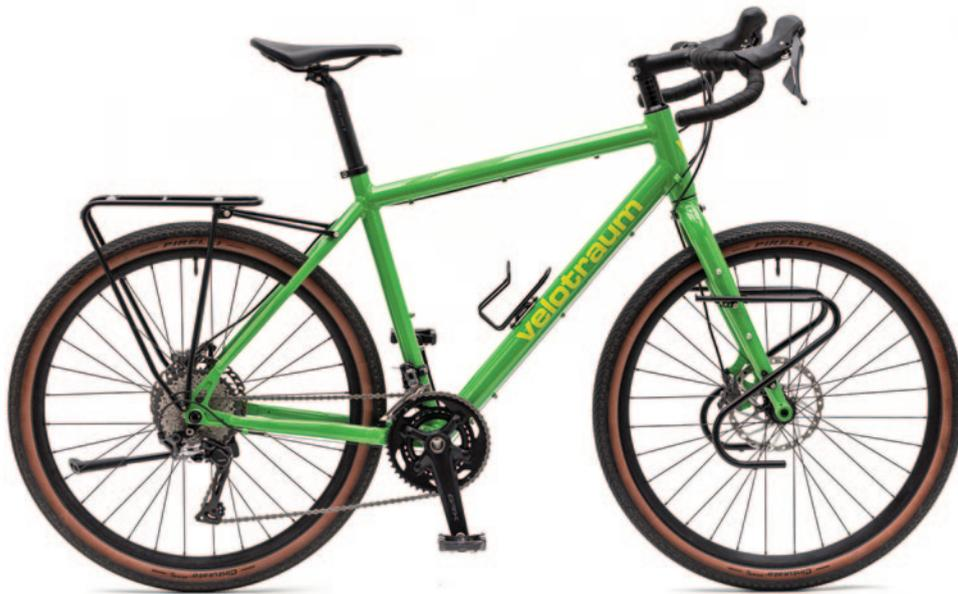
▲ **27,5//28** – Es ist leicht zu erkennen, dass die Größenunterschiede zwischen 27,5 und 28 Zoll gering ausgeprägt sind, zumindest wenn man nicht Äpfel mit Birnen vergleicht. Die oben abgebildeten Reifenformate 50-584 und 40-622 sind hinsichtlich Gewicht, rotierender Masse und Umfang nahezu identisch und somit vergleichbar. Mit diesem tatsächlichen Unterschied vor Augen kann nun jeder für sich entscheiden, welchen Argumenten und Aspekten er bei der Laufradgröße folgen möchte.
