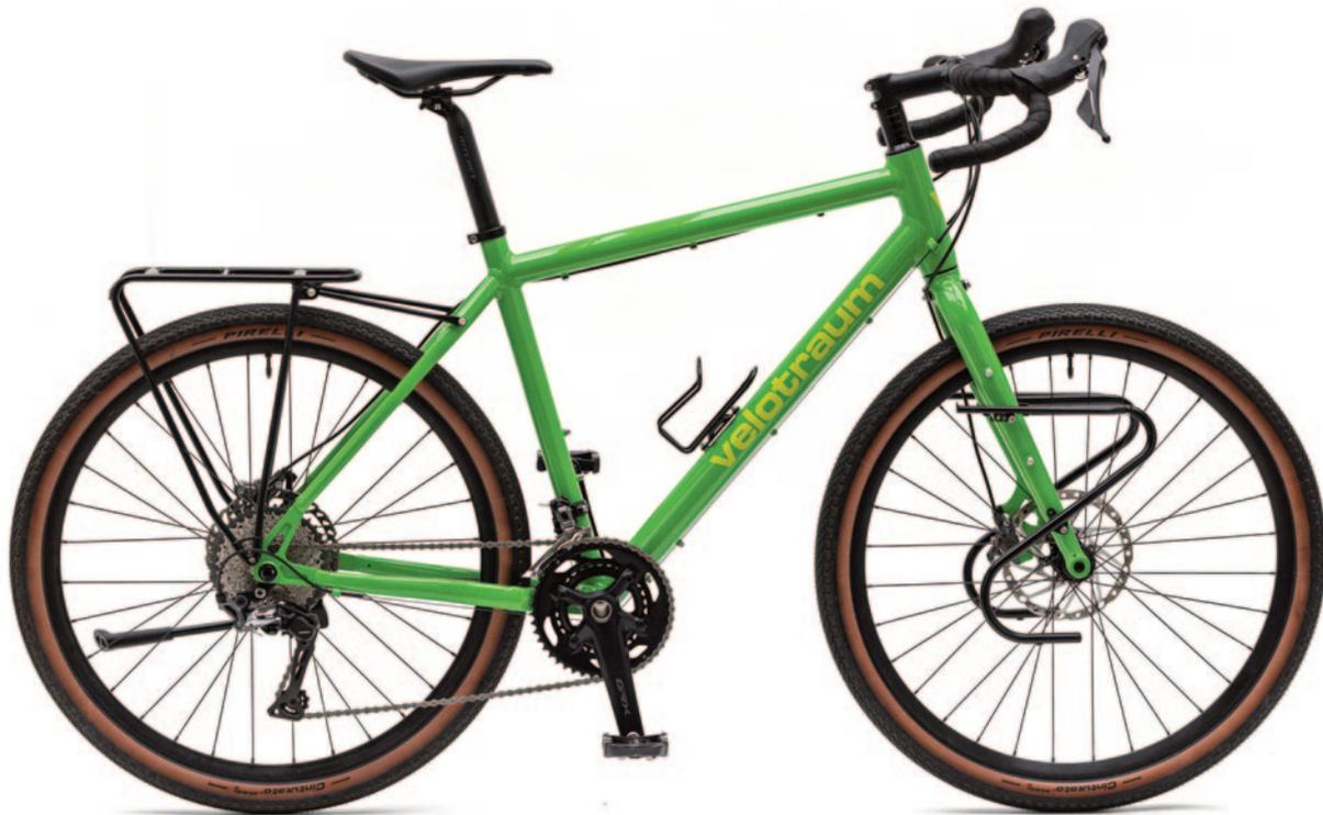
Abbildung: Rahmen S100 – Farbe RAL 6018 – Größe »L« – Reifenformat 50-584 mm – Gewicht 13,2 kg
