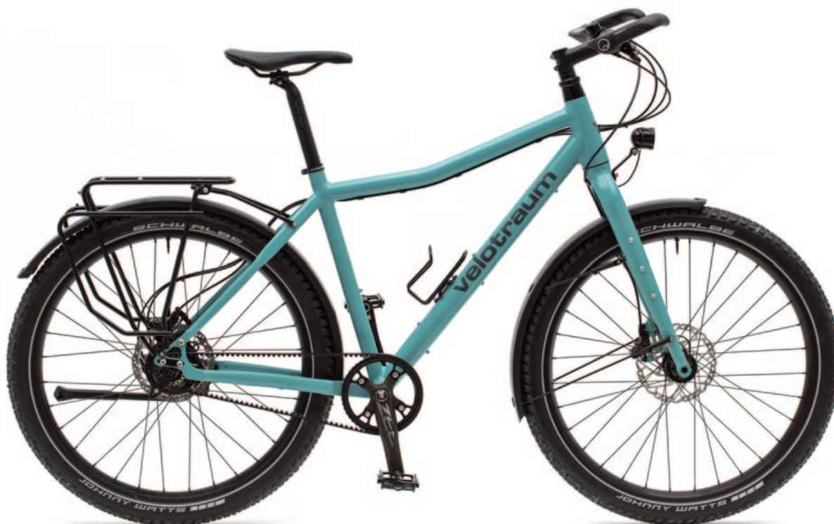
Abbildung: Rahmen F900 – Farbe RAL 6034 – Größe »L« – Reifenformat 65-584 mm – Gewicht 16,6 kg
