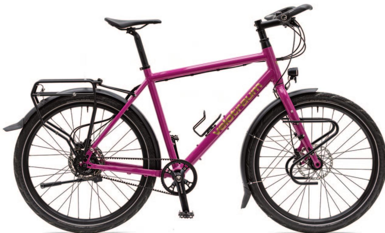
Abbildung: Rahmen R900 – Farbe RAL 4006 – Größe »XL« – Reifenformat 55-584 mm – Gewicht: 16,9 kg
