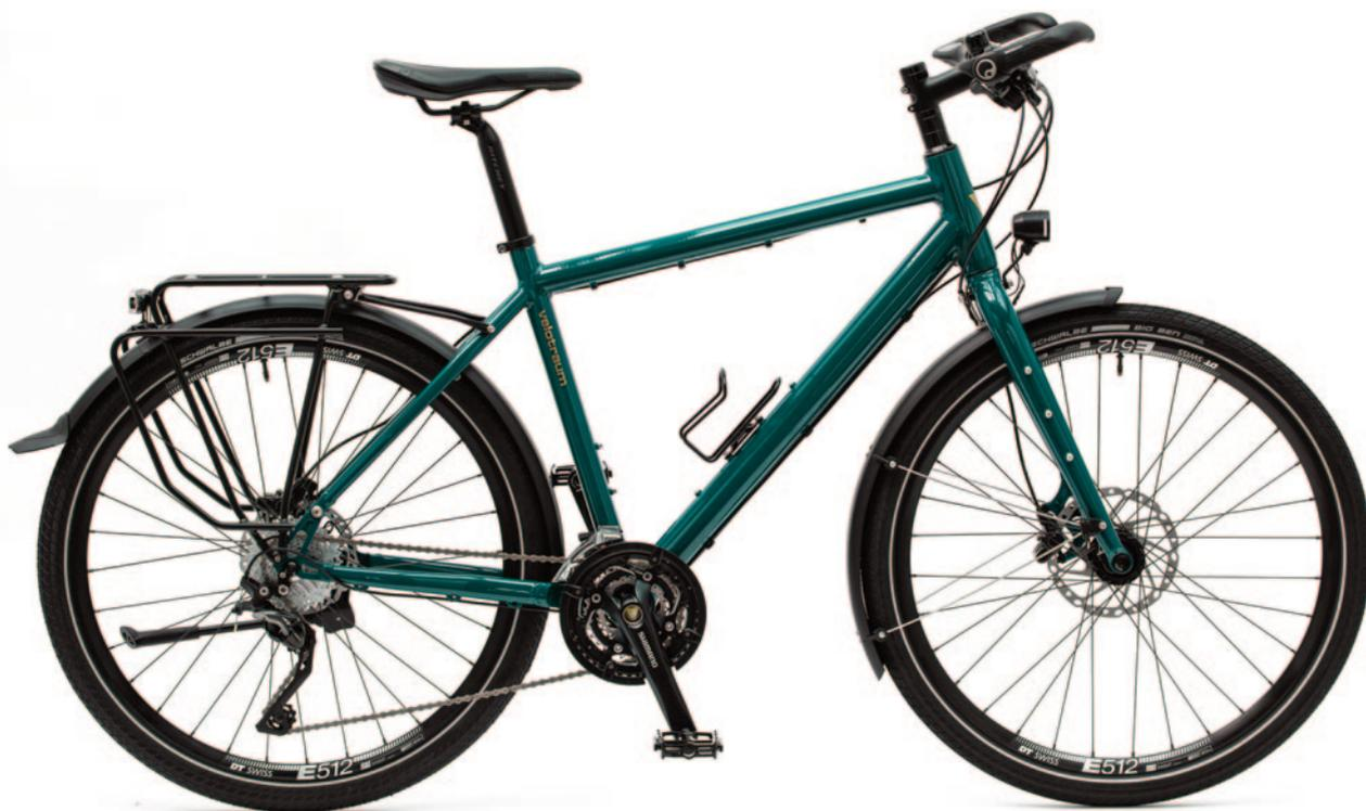
Abbildung: Rahmen R900 – Farbe: RAL 6033 – Größe »L« – Reifenformat: 50-584 mm – Gewicht: 14,9 kg
