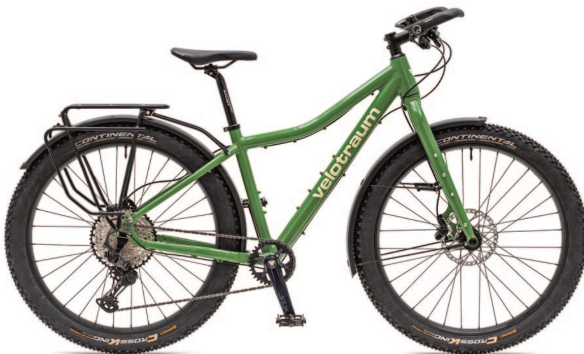
Abbildung: Rahmen F900 – Farbe RAL 6011 – Größe »S« – Reifenformat 65-584 mm – Gewicht 14,3 kg
