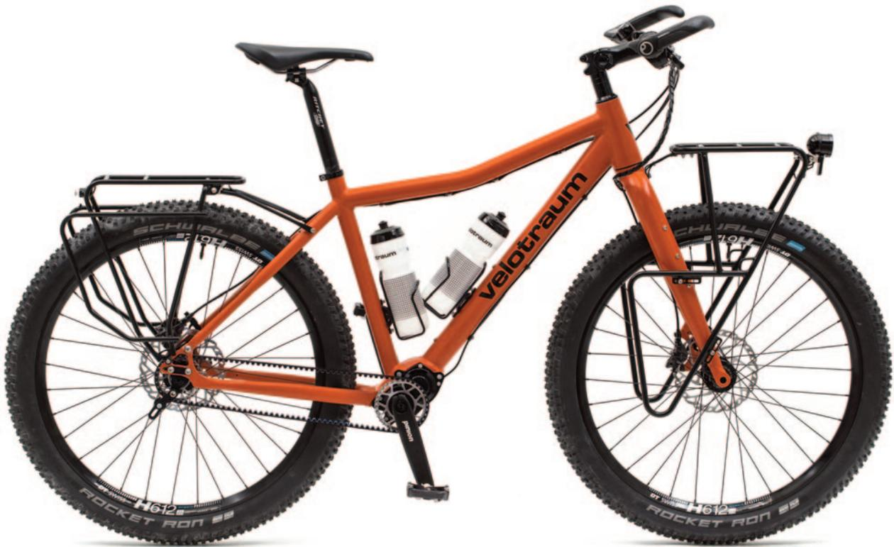
Abbildung: F6 für Nomads Trail's – Rahmen: F900 – Farbe: RAL 2001 – Größe »L« – Reifenformat: 65-584 mm – Gewicht: 16,8 kg
