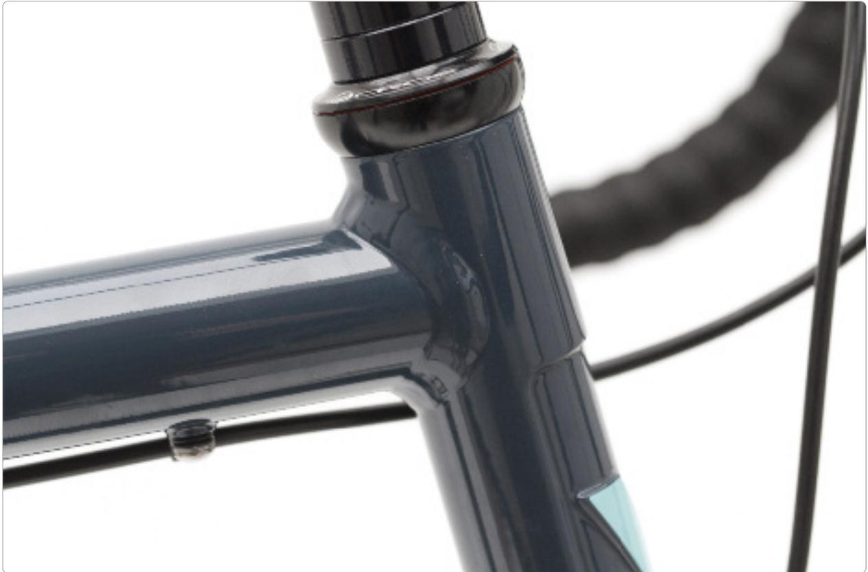
**Smart-Steuerrohr** — Speziell an den hoch belasteten Stellen wie an den Lagerschalen des Steuersatz und dem Fügebereich von Unter- und Steuerrohr haben wir bei unserem Steuerrohr mehr Wandstärke als üblich. Gestalterisches Nebenprodukt: Das aus dem vollen gefräste V-Logo.
