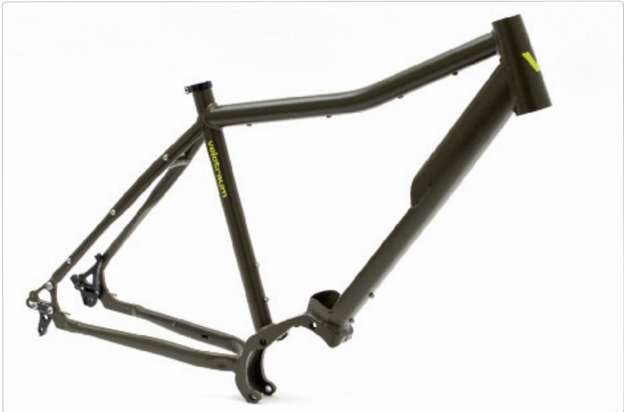
**FD100E-Rahmen** – Für den Laien sieht das Ganze nur noch ungefähr nach einem Fahrradrahmen aus mit komischen Öffnungen und Löchern. Der Kenner sieht eine Vielzahl von aufwändigen CNC-Teilen (Steuerrohr, Interface, Ausfallenden, Slider), Formteilen und einem tiefgezogenem Unterrohr.
