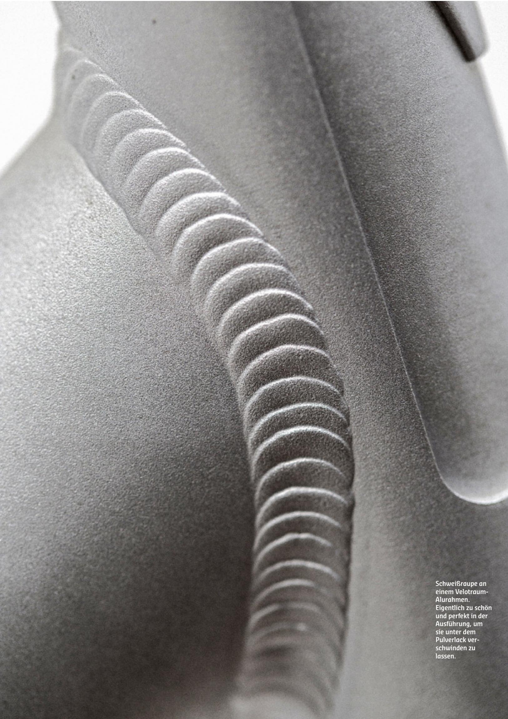
Schweißnaht an einem Velotraum-Alurahmen. Eigentlich zu schön und perfekt in der Ausführung, um sie unter dem Pulverlack verschwinden zu lassen.
