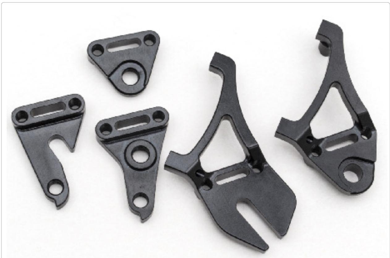
**Modular** — Bei den Rahmen FD-1300 (Pinion) und FD-100E (Pedelec) erlauben verschiedene »Slider« den optimalen Einsatz von Schnellspannern oder Steckachsen (FD-1300) sowie Ketten- oder Nabenschaltung (FD-100E). Zum Spannen der Kette bzw. des Riemens lassen sich die Slider in den Ausfallenden um 15 Millimeter verschieben.
