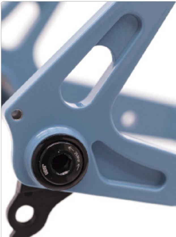
Speziell entworfenes Ausfallende mit UDH-Universal-Ausfallende und Steckachse im VT-100-Rahmen
