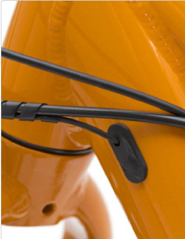
Die Verlegung von Elektrokabeln, Bremsleitung und Bowdenzügen folgt einem bewährten Prinzip: »Strom« läuft im Rahmen und die »Mechanik« wartungsfreundlich außen.
