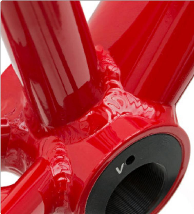
**Exzenter** — Der Goldstandard zum Spannen der Kette bei Fahrrädern mit Nabenschaltung. Das aufwändige Tretlagergehäuse ist ein hochfestes, überfrästes Strangpressprofil, das nach dem Schweißen erst geschlitzt und präzise auf Maß gebracht wird.
