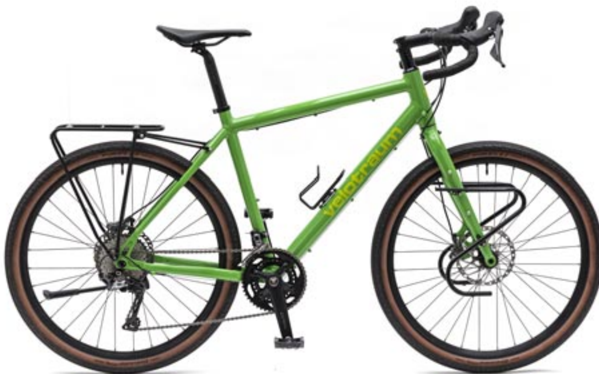
Abbildung: Rahmen S100 – Farbe RAL 6018 – Größe »L« – Reifenformat 50-584 mm – Gewicht 13,2 kg
