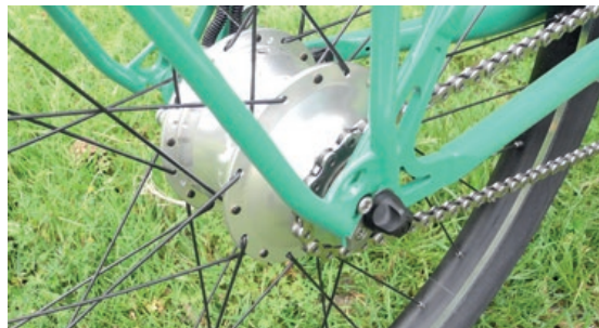
Zuverlässig und wartungsarm: Nabenschaltungen gehören zur Sorglos-Ausstattung.
