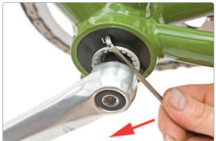
3 Um die Kettenspannung zu erhöhen, einfach den 4er-Inbus mit der kurzen Seite in das Loch neben dem »L« stecken – die lange Seite stützt sich rechts auf der Innenlagerachse ab – und mit Gefühl den Exzenter verdrehen.
