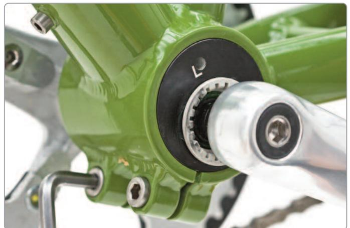
2 Lösen Sie die Spannschrauben soweit, dass der Schraubenkopf zwei Millimeter übersteht. So ist gewährleistet, dass der Exzenter sich leicht bewegen lässt.
