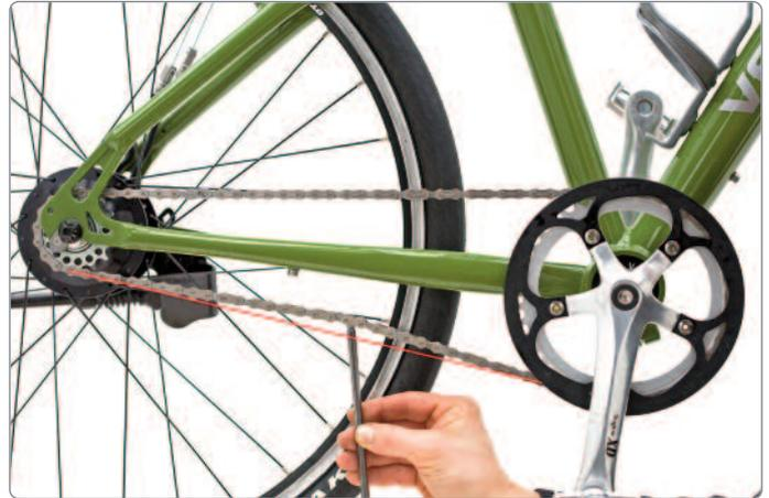
1 Kettenspannung prüfen. Sobald sich die Kette sichtbar nach oben drücken lässt – mehr wie einen Zentimeter – muss die Kettenspannung erhöht werden.
