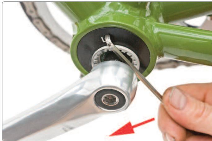
3 Um die Kettenspannung zu erhöhen, einfach den 4er-Inbus mit der kurzen Seite in das Loch neben dem »L« stecken – die lange Seite stützt sich rechts auf der Innenlagerachse ab – und mit Gefühl den Exzenter verdrehen.
