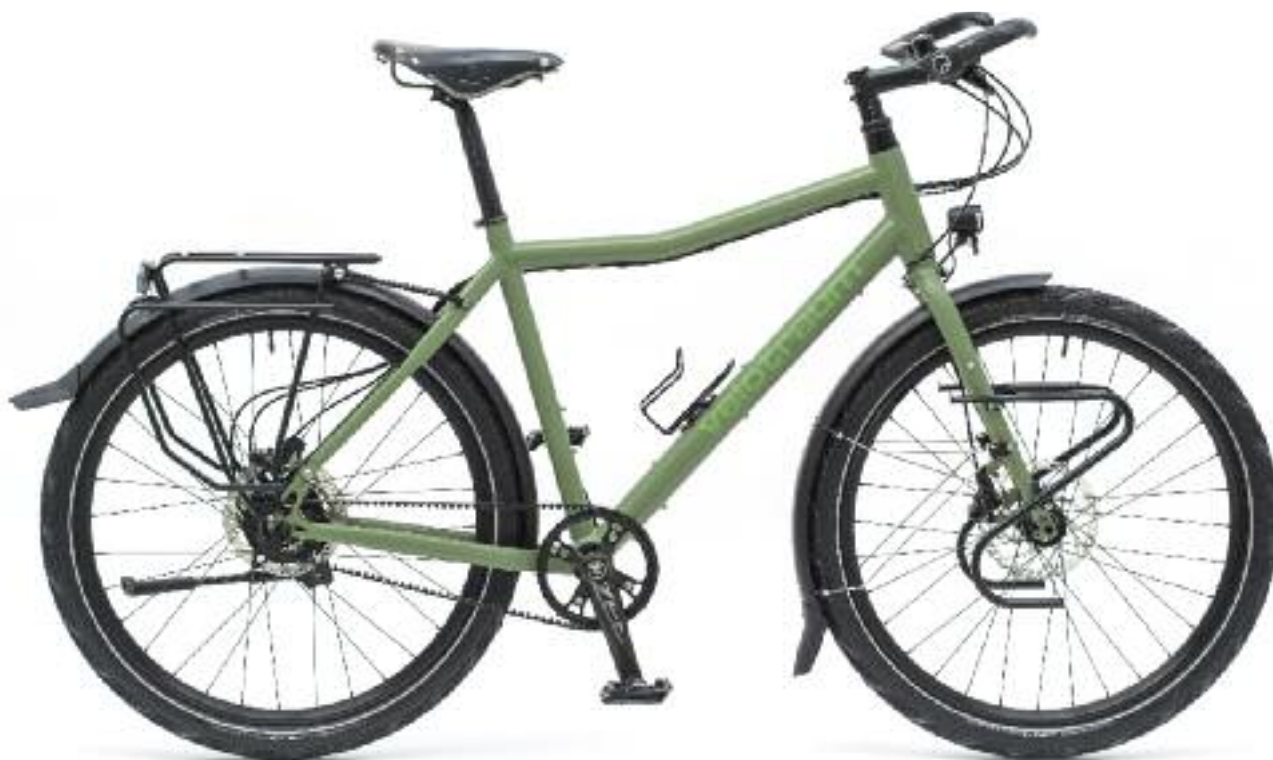
Abbildung: Musterrad (Serie hat gerades Oberrohr) – Rahmen: R900 – Farbe: RAL 6000 – Größe »L« – Reifenformat: 55-584 mm – Gewicht: 16,9 kg Hinweis: Das abgebildete Beispiel für ein »R4« beinhaltet Wahloptionen
